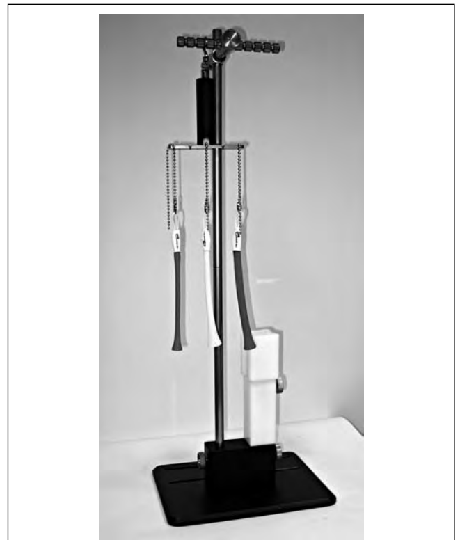
Fig. 18. Torre di trazione di Borelli.
